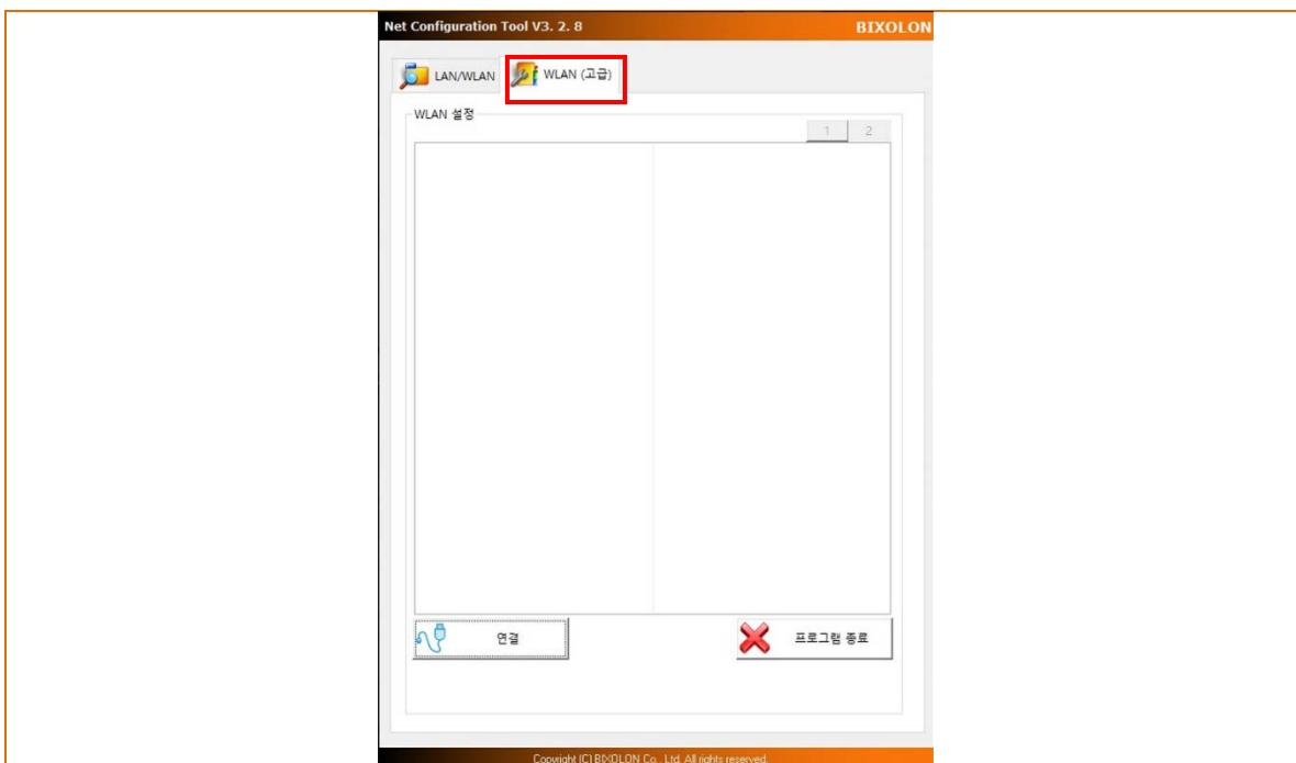
2) 연결 버튼을 클릭하여 USB 연결 후, 사용 중인 네트워크에 맞는 네트워크(WLAN), 인증방법, 암호화 방법 등의 설정을 한 후, 저장 버튼을 누르면 설정값이 저장됩니다.
